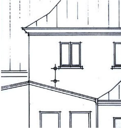
Höchster Punkt des Daches des neuen Anbaus unterhalb der Fenster im Obergeschoss
